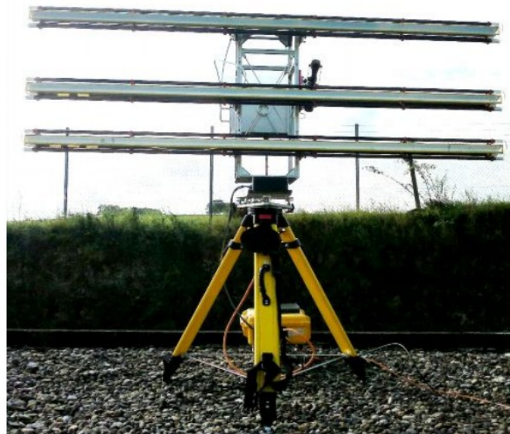
Рис.1. Наземный радарный интерферометр GPRI-2, установленный над репером
