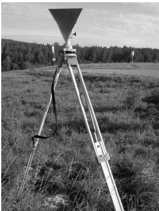
Рис.3. Рефлектор, установленный над геодезическим пунктом на полигоне твердых бытовых отходов
