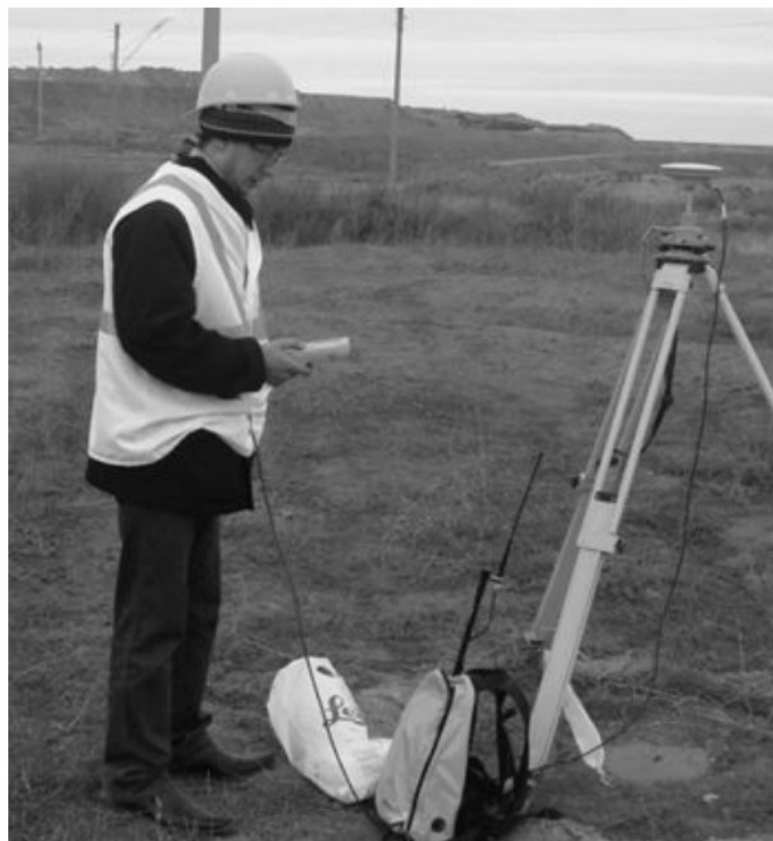
б – наблюдения с помощью ГНСС (карьер Варваринский-Центральный)
