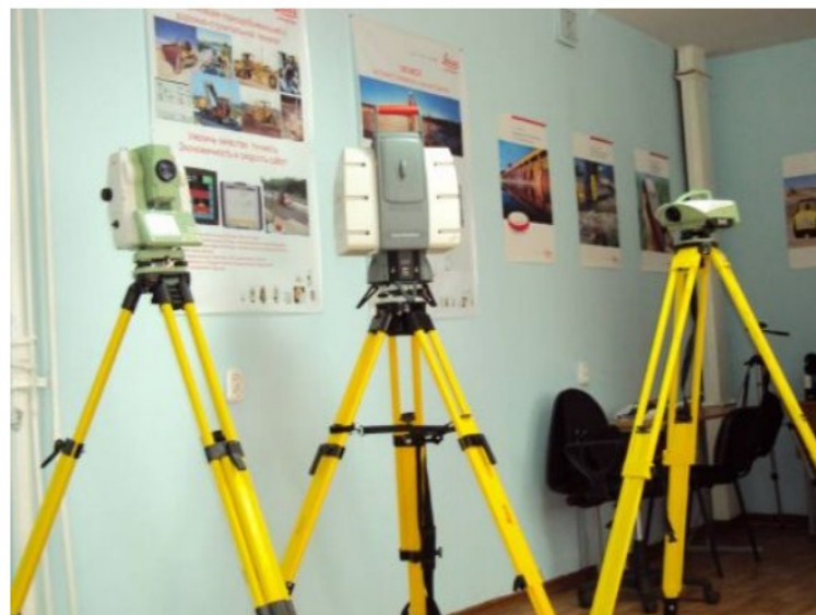
Рис.1. Современное материально-техническое оснащение кафедры (слева направо): электронный тахеометр совмещенный с GPS, сканер и цифровой нивелир
