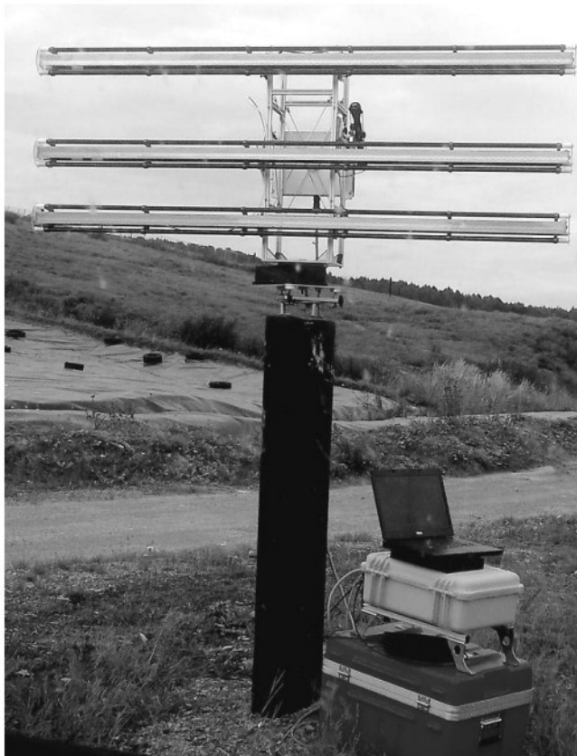
Рис.2. Мониторинг рекультивационных работ наземным радарным интерферометром GPRI-2 на полигоне твердых бытовых отходов
